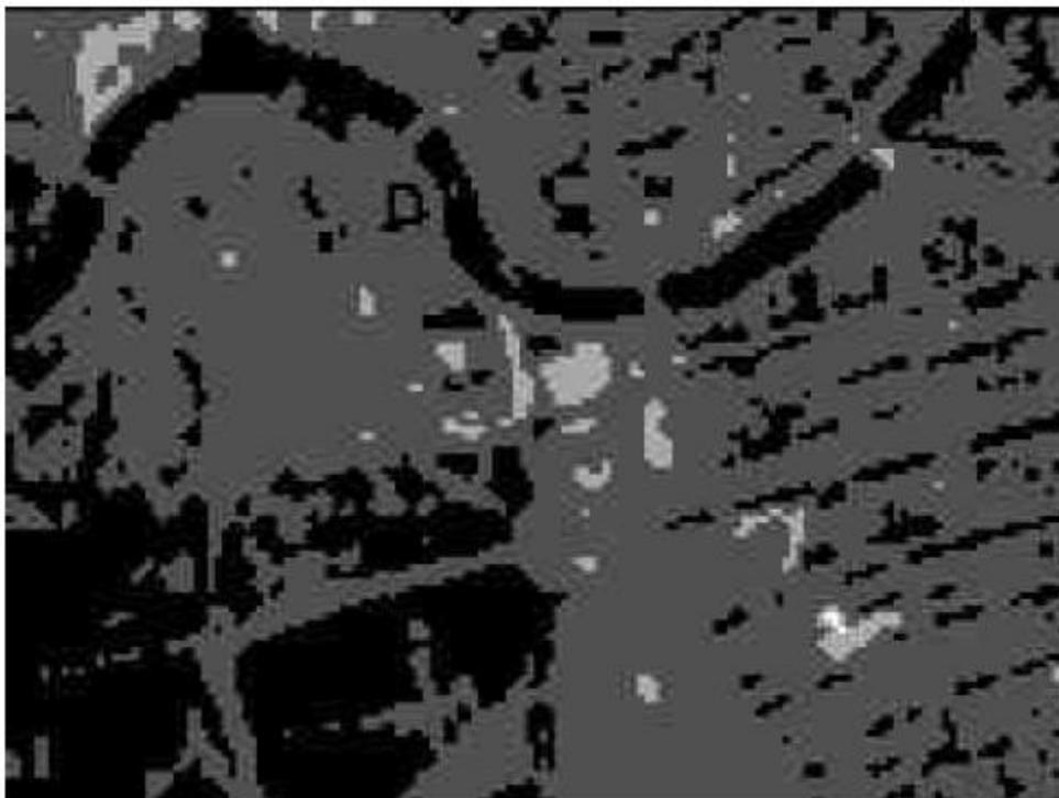
Радиометрическое разрешение 2 бита
